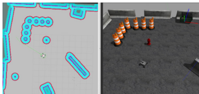
Abbildung 8: Szenario für die virtuelle Validierung eines mobilen Roboters mit ROS (©Fraunhofer IIS)
